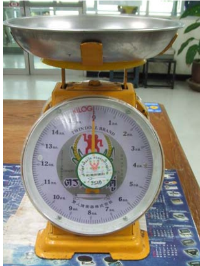
ภาพที่ 2 ภาพเครื่องชั่งที่ได้รับการตรวจรับรองเครื่องชั่งชั้นแรก และติดสติ๊กเกอร์ว่าเครื่องชั่งมีมาตรฐานเที่ยงตรงถูกต้องจากสำนักชั่งตวงวัด
