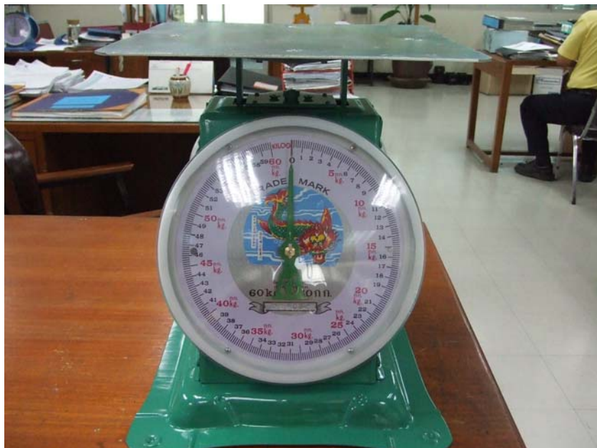
ภาพที่ 1 ภาพเครื่องซั้งที่ยังไม่มีการติดสติ๊กเกอร์ ว่าได้รับการตรวจรับรองเครื่องซั้งจากนายตรวจซั้งตวงวัด
